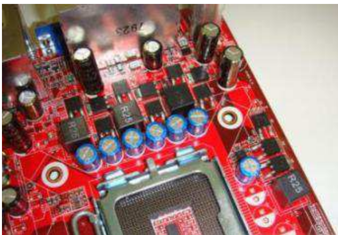
Gambar 12: Motherboard dengan tiga phase, walaupun kelihatan empat phase.
