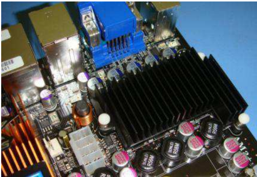
Gambar 3: Motherboard dengan heatsink pasif diatas transistors.
